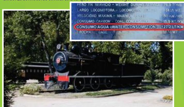
Imagen 5. Fotografía de una locomotora, construida entre 1905 y 1907, que se encuentra en el cementerio de trenes de Santiago de Chile. Se puede leer en su placa, arriba a la izquierda, que su consumo de agua era de 127.2 litros por km. Haciendo los cálculos correspondientes, para un viaje de 1000 km por día era necesario tener una fuente con un caudal de 1.5 litros por segundo.
